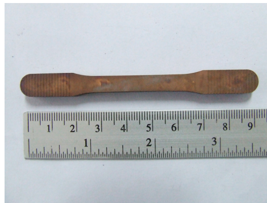
รูปที่ 3.1 ลักษณะชิ้นงานตามมาตรฐาน ASTM E 8
