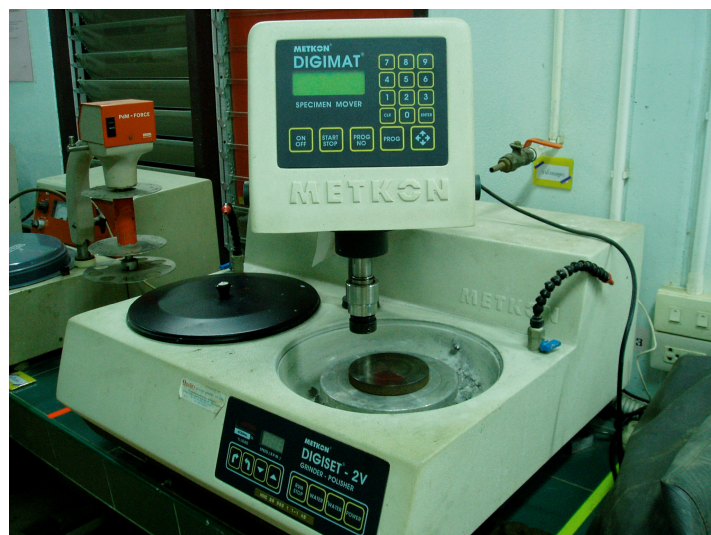
รูปที่ 3.2 เครื่องทดสอบการสึกหรอ Wear Test ที่ประยุกต์ใช้
