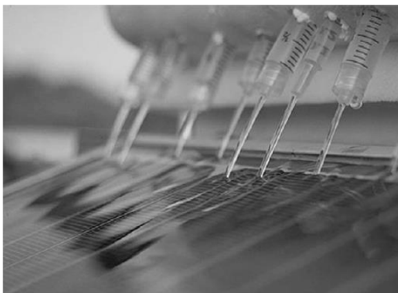
รูปที่ 2.32 การสร้างฟิล์มน้ำไหลผ่านพื้นผิวรับแสงโดยใช้หัวฉีดจำนวน 12 หัว [11]
