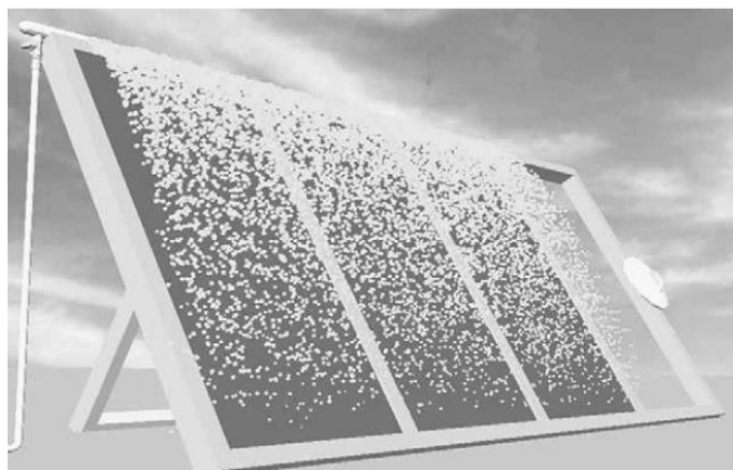
รูปที่ 2.33 การระบายความร้อนให้แผงPVด้วยวิธีการพ่นละอองน้ำที่ผิวรับแสง [12]
