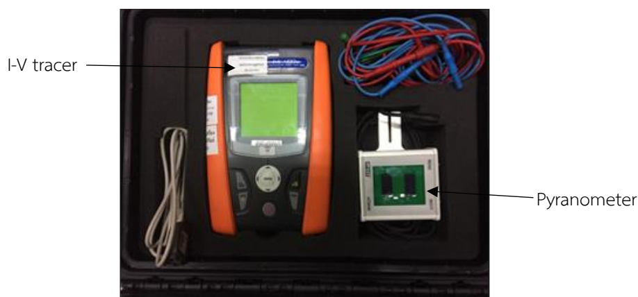
รูปที่ 3.20 ชุดอุปกรณ์วัดประสิทธิภาพทางไฟฟ้าของแผงPV
