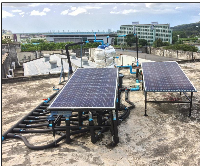
รูปที่ 4.37 ภาพถ่ายระบบแผง PV/T และแผง PV สำหรับการทดสอบจริง ที่ติดตั้ง ณ ดาดฟ้า ภาควิชาคอมพิวเตอร์ คณะวิศวกรรมศาสตร์ มหาวิทยาลัยสงขลานครินทร์ (พิกัด 7° 00' 15.6"N 100° 30' 65.4" E)
