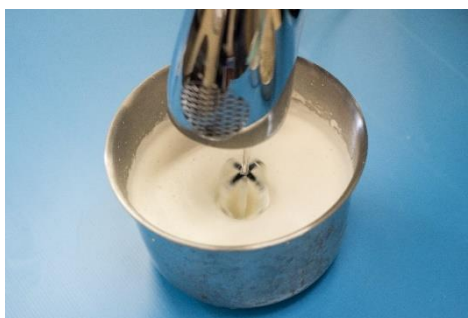
รูปที่ 3.12 กวนด้วยความเร็วต่ำ พร้อมใส่ ZnO กับ DPG และสารก่อเจล
