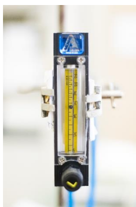
รูปที่ 3.4 อุปกรณ์วัดอัตราการไหลที่อัตราการไหล 0-120 มิลลิลิตรต่อนาที
