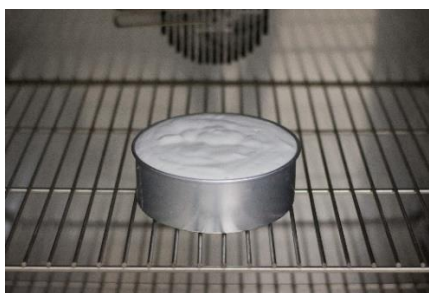
รูปที่ 3.20 การวัลคาไนซ์ของฟองยางในเตาอบ
