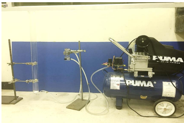
รูปที่ 3.10 การติดตั้งอุปกรณ์ของกระบวนการไมโครบับเบิล ปั๊มลมอากาศเชื่อมต่อกับเครื่องวัดอัตราการไหลและเชื่อมต่อกับบับเบิลคอลัมน์ลักษณะทรงกระบอกที่ติดอยู่กับแผ่นดิฟฟิวเซอร์
