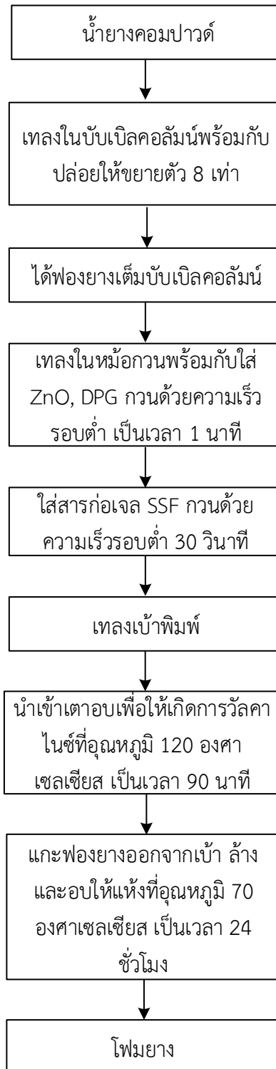
รูปที่ 3.16 วิธีการเตรียมฟองยางธรรมชาติด้วยกระบวนการไมโครบำบัด
