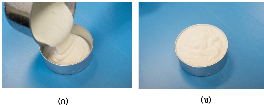
รูปที่ 3.19 (ก) แสดงการนำฟองยางเทใส่เบ้าพิมพ์ (ข) ฟองยางเกิดการเจลในเบ้าพิมพ์
