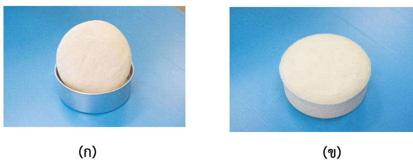
รูปที่ 3.21 (ก) แกะฟองยางออกจากเบ้าพิมพ์ (ข) ผลิตภัณฑ์ฟองยางธรรมชาติ
