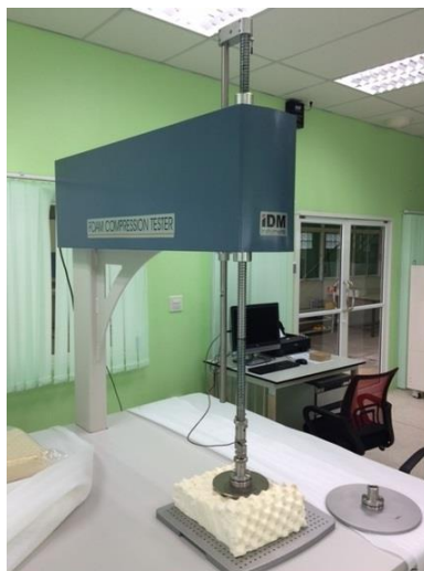
รูปที่ 3.25 เครื่องทดสอบดัชนีความแข็งเชิงกด [49]
