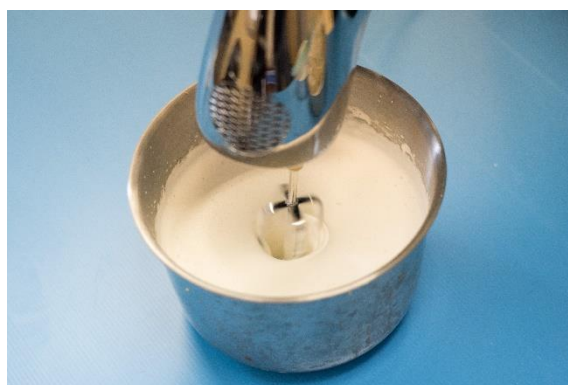
รูปที่ 3.18 กวนด้วยความเร็วรอบสูงเพื่อให้เกิดฟอง พร้อมกับใส่ ZnO กับ DPG และสารก่อเจล
