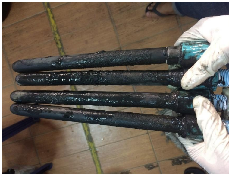
รูปที่ 4 – 16 ลักษณะการสะสมของตะกอนบนพื้นผิวเมมเบรนของชุดเมมเบรนของระบบ AnMBR
