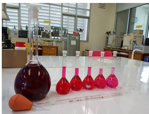
ภาพประกอบที่ 3-13 ตัวอย่างการเตรียมน้ำเสียสังเคราะห์ สีแดง RDR195
