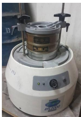
ภาพประกอบที่ 3-7 ชุดตะแกรงร่อนตามมาตรฐานไทเลอร์ (ขนาดเมช 12 และ 28)
