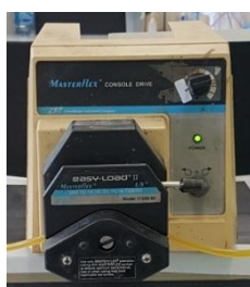
ภาพประกอบที่ 3-10 ป้อนดูดจ่ายของเหลวแบบรีดท่อ ยี่ห้อ Cole-Parmer รุ่น Masterflex ® L/S
