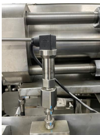
ภาพที่ 4.38 อุปกรณ์วัดแรงดัน (Pressure transmitter)
