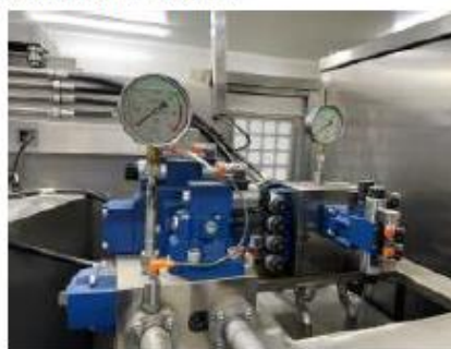
รูปที่ 4.10 ระบบไฮดรอลิก (Hydraulic station)
