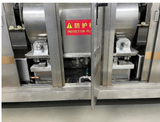
ภาพที่ 4.21 ฐานของภาชนะแรงดัน (Yoke of vessel)
