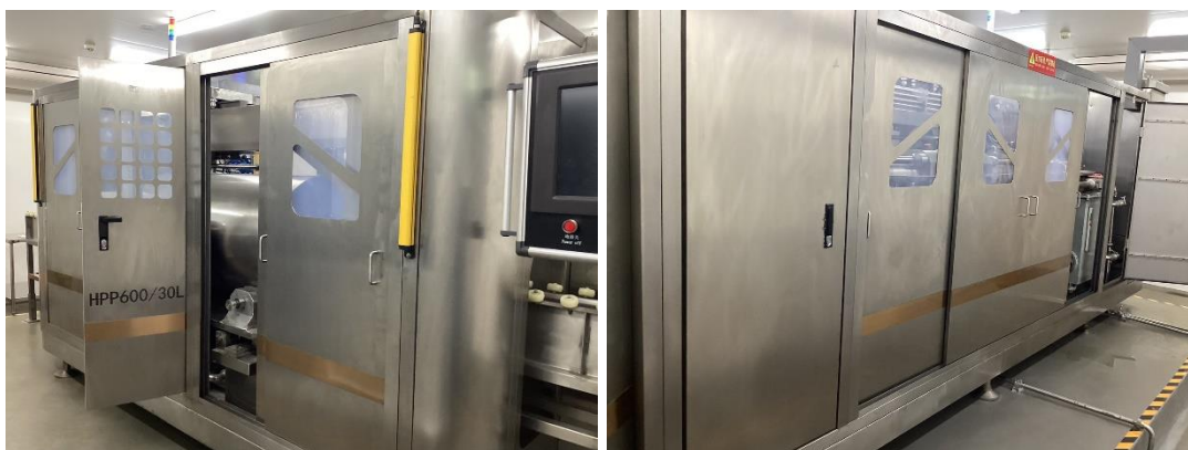
ภาพที่ 4.11 โครงสร้างภายนอกเครื่องฆ่าเชื้อด้วยแรงดันสูงขนาด 30 ลิตร
