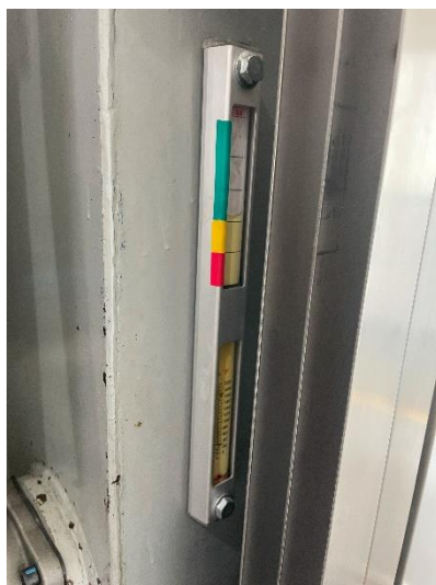
ภาพที่ 4.24 เกจวัดระดับน้ำมันไฮดรอลิก (Hydraulic)
