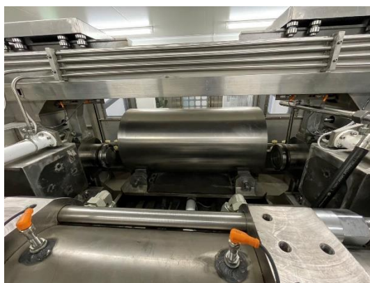
ภาพที่ 4.12 โครงสร้างภายในเครื่องฆ่าเชื้อด้วยแรงดันสูงขนาด 30 ลิตร
