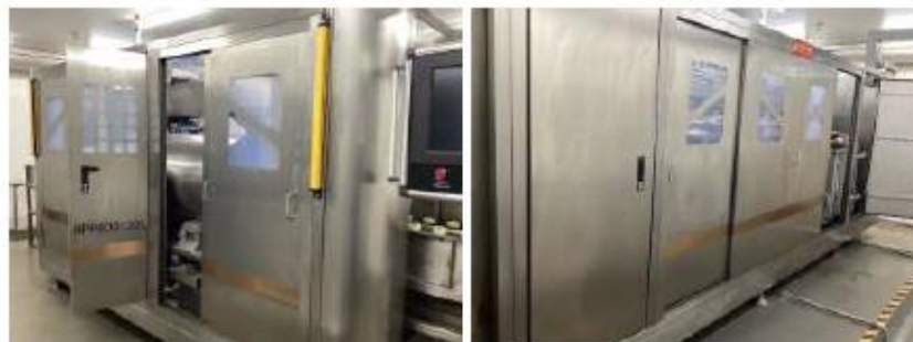
รูปที่ 4.9 โครงสร้างภายนอกเครื่องฆ่าเชื้อด้วยแรงดันสูงขนาด 30 ลิตร
