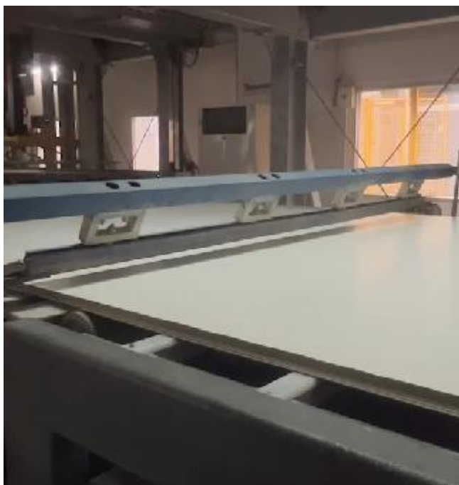
ภาพที่ 4.20 การทำงานเครื่อง static ยึดกระดาษให้ติดกับผิวบนและผิวล่าง
