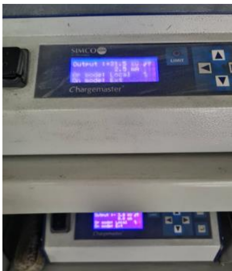
ภาพที่ 4.19 การตั้งค่ากระแสไฟฟ้าเครื่อง static กระดาษผิวบนและกระดาษผิวล่าง
