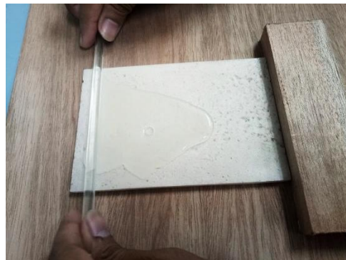
รูปที่ 3.5 การเคลือบผิวโฟมแข็งด้วยไซซีผึ้ง
