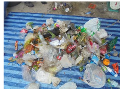
6) นำมูลฝอย 2 กองที่อยู่ตรงกัน
