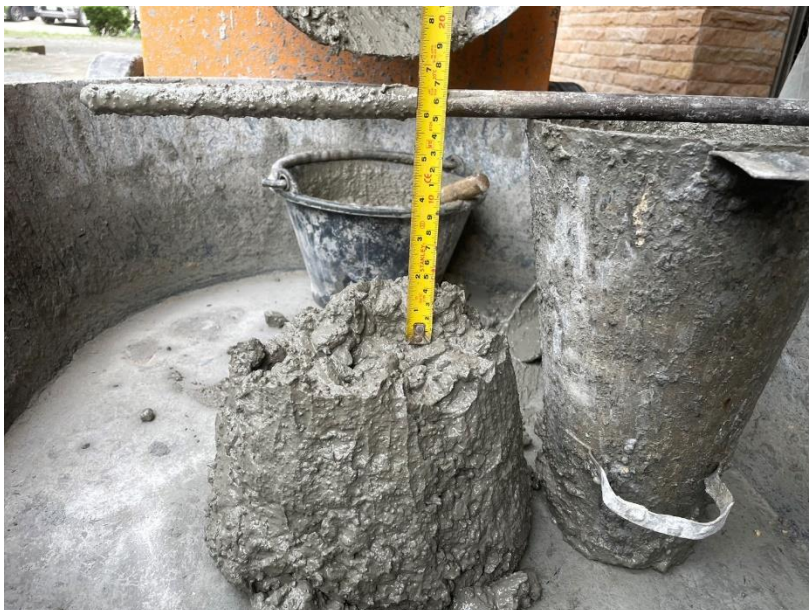
รูปที่ 3.11 การทดสอบการยุบตัวของคอนกรีต
