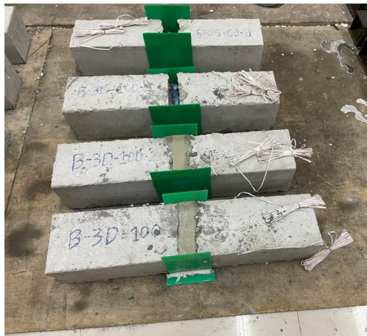
รูปที่ 3.17 การเทคอนกรีตสมรรถนะสูง และปูนนอนซริงเพื่อเชื่อมต่อคาน
