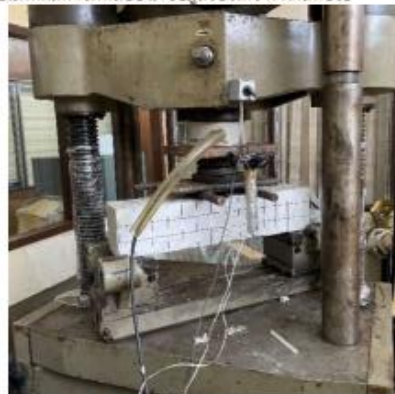
รูปที่ 6 การติดตั้งตัวอย่างคานเพื่อทดสอบ
