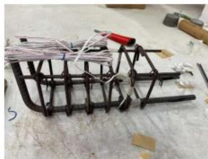
รูปที่ 2 การผูกเหล็กและติดตัววัดความเครียด (strain gauge)
