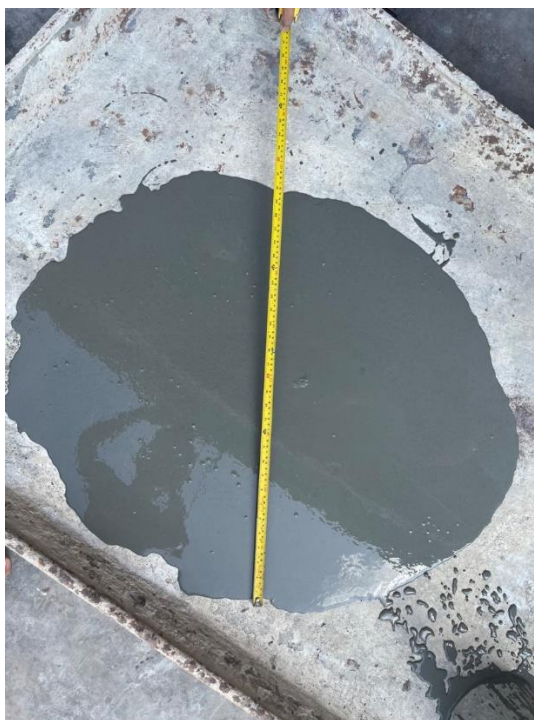
รูปที่ 3.15 การทดสอบการไหลของคอนกรีตสมรรถนะสูง (UHPC)
