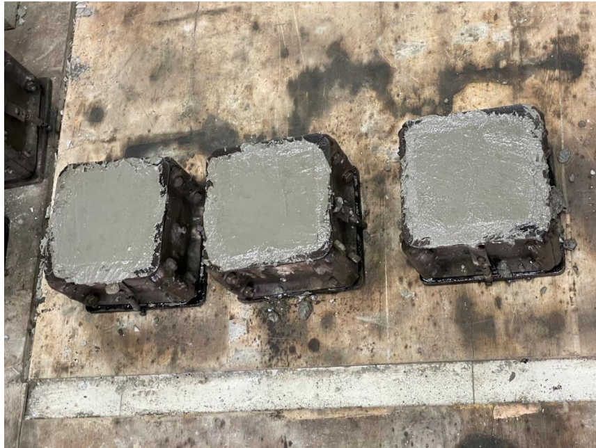
รูปที่ 3.16 การเก็บตัวอย่างคอนกรีตสมรรถนะสูง
