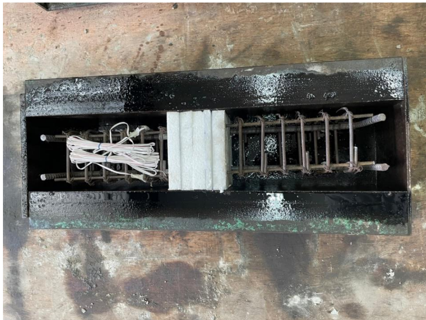
รูปที่ 3.9 การใส่คานที่มีจุดเชื่อมต่อลงในแบบ
