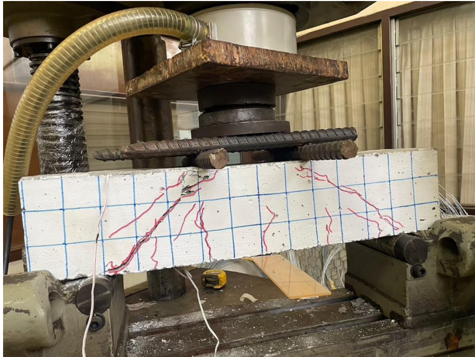
รูปที่ 3.21 ตัวอย่างคานเมื่อทำการทดสอบ และเกิดการวิบัติ
