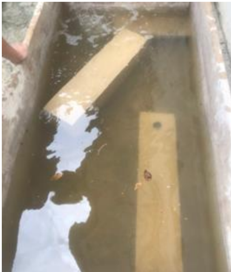
รูปที่ ง.3 การบ่มคอนกรีตด้วยน้ำในบ่อพัก
