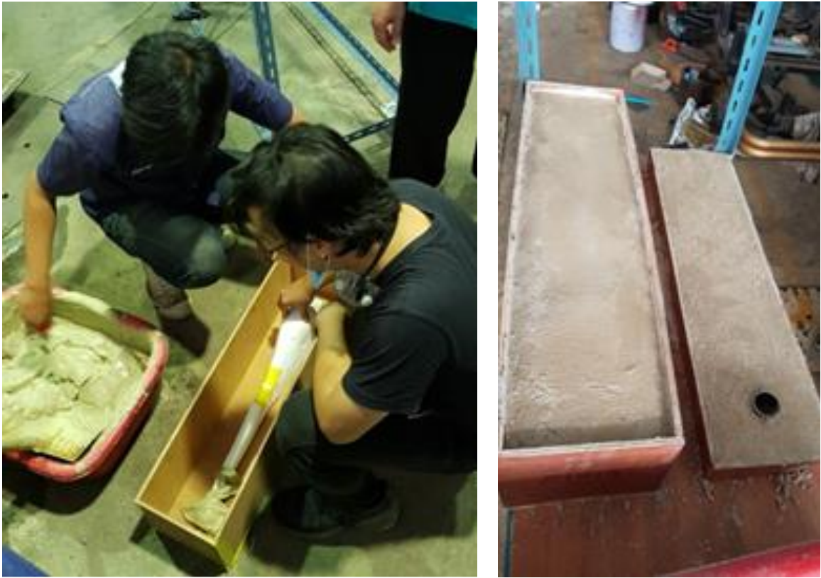
รูปที่ ง.2 ภาพการหล่อคอนกรีตลงเข้าไม้
