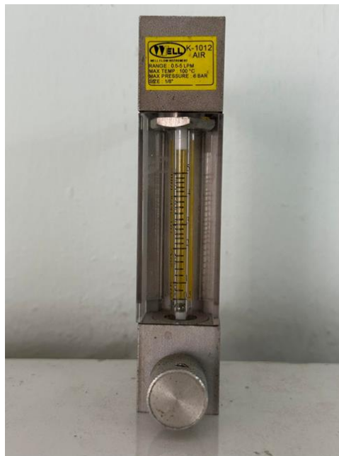
รูปที่ ๓.9 Air Flow meter
