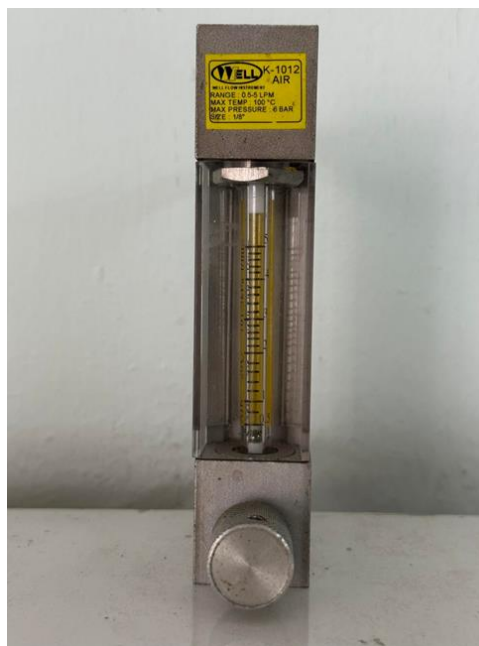
รูปที่ ๓.9 Air Flow meter
