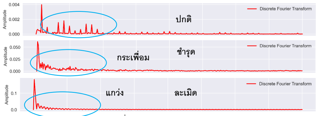
ภาพประกอบที่ 4-20 ตัวอย่างค่า DFT ของแรงดัน
