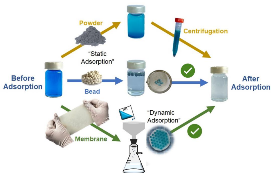
รูปที่ 2.2 ชนิดของตัวดูดซับและการทำงานของตัวดูดซับในกระบวนการดูดซับ
