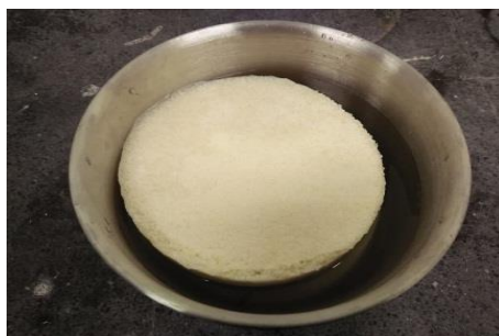
รูปที่ 3.19 การล้างโฟมยางเพื่อกำจัดน้ำสบู่
