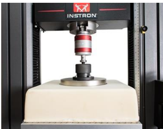
รูปที่ 3.27 เครื่องทดสอบแรงอัดที่ใช้ในการทดสอบดัชนีความแข็งเชิงกด
