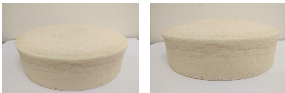
รูปที่ 3.21 โคมยางที่ผลิตจากฟองก๊าซไนโตรเจนด้วยกระบวนการไมโครบับเบิล
