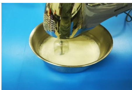
รูปที่ 3.16 การกวนฟองยางหลังจากการเติมสารก่อเจล
