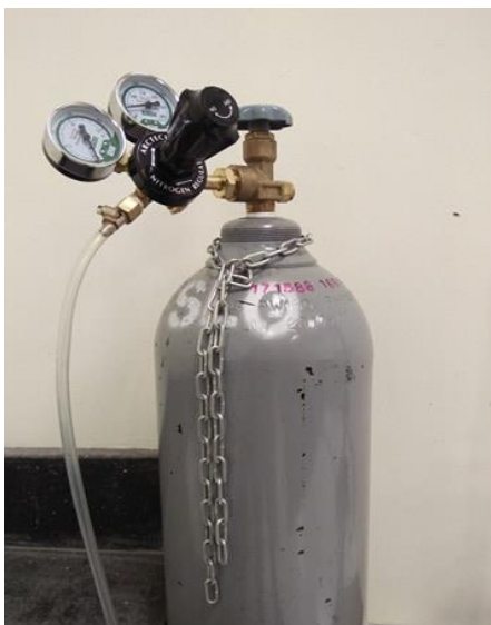
รูปที่ 3.1 ถังบรรจุก๊าซไนโตรเจนพร้อมตัวติดตั้งอุปกรณ์วัดแรงดัน (Pressure gauge)
