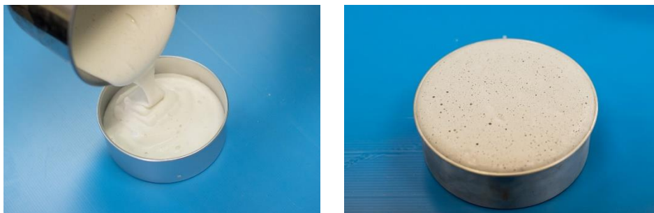
รูปที่ 3.17 การเทฟองยางลงสู่แม่พิมพ์
