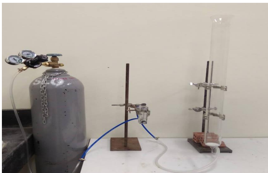
รูปที่ 3.13 การติดตั้งอุปกรณ์ของกระบวนการไมโครบับเบิลด้วยก๊าซไนโตรเจน
