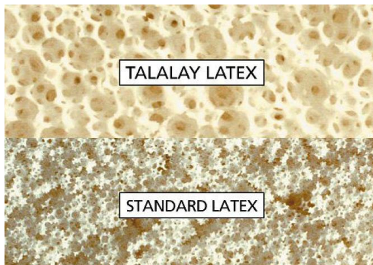
รูปที่ 2.7 เปรียบเทียบลักษณะของเซลล์ที่ได้จากกระบวนการทาลาเลย์และกระบวนการดันลอป [24]
