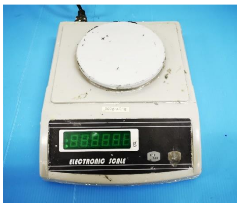
รูปที่ 3.6 เครื่องชั่งแบบทศนิยม 2 ตำแหน่ง
