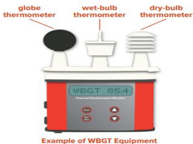
ภาพที่ 2-2 เวตบัลบ์โกลบเทอร์โมมิเตอร์ (Wet bulb glob thermometer)(48)
