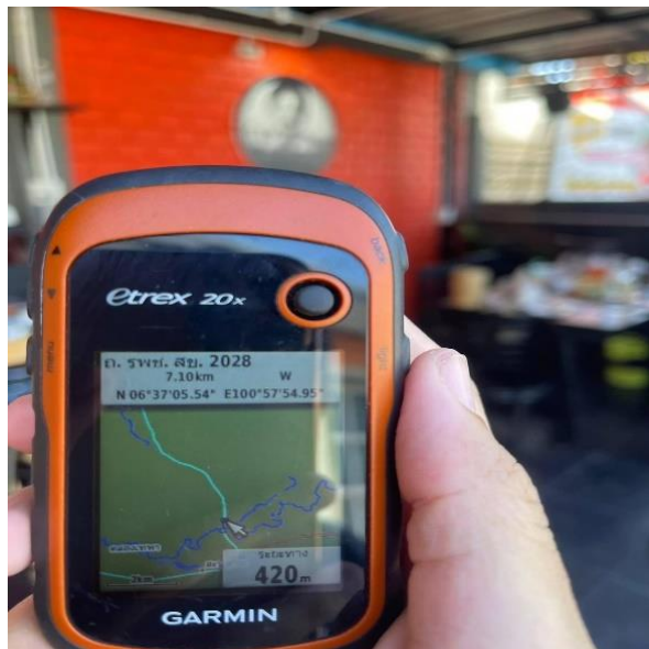
ภาพที่ 43 การใช้เครื่องมือเครื่องหาพิกัดด้วยสัญญาณดาวเทียม GPS เพื่อจับพิกัดเส้นทางการท่องเที่ยวชุมชนในพื้นที่พัฒนาพิเศษเฉพาะกิจ จังหวัดชายแดนภาคใต้
