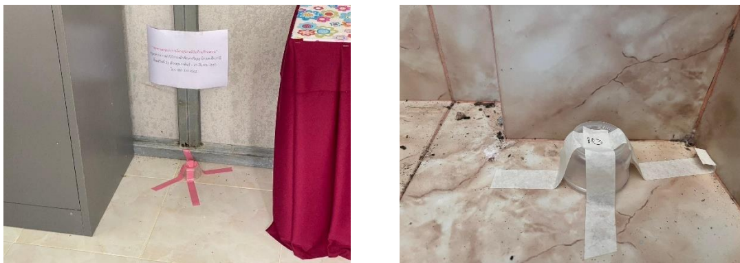
ภาพที่ 3.7 การติดตั้งอุปกรณ์บันทึกรอยอนุภาคแอลฟา ชนิด CR-39 ภายในห้องเรียนของอาคาร
