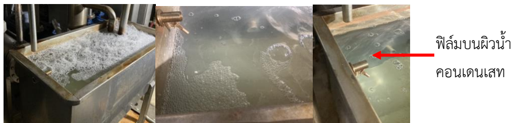
รูปที่ 4.5 ลักษณะฟองและฟิล์มบนผิวน้ำของน้ำคอนเดนเสทที่ pH สูง
