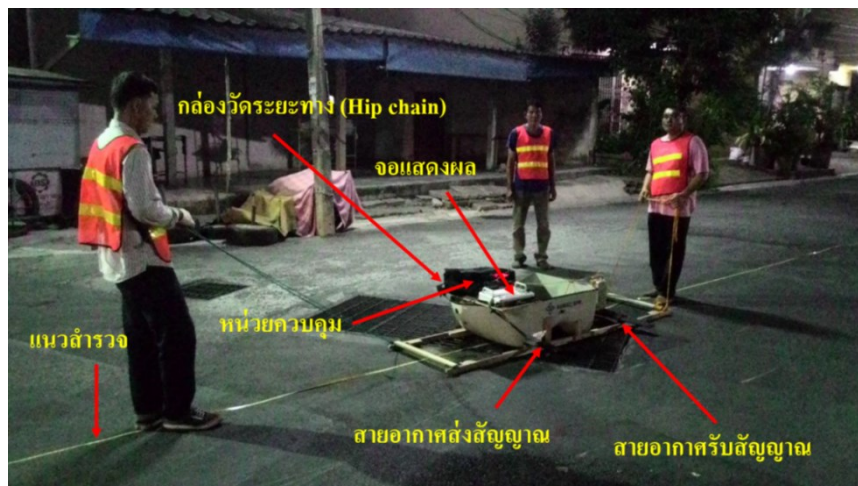
รูปที่ 3.3 ชุดอุปกรณ์การสำรวจ GPR ที่ความถี่สายอากาศ 200 MHz, 100 MHz และ 50 MHz
