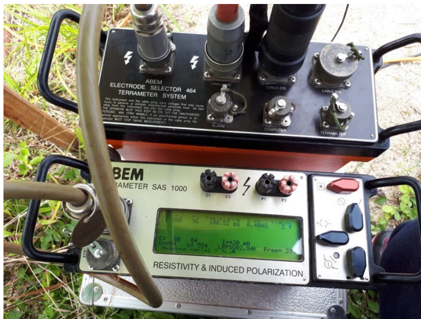
รูปที่ 3.2 รูปเครื่องวัดค่าสภาพต้านทานไฟฟ้า Terameter SAS 1000 ที่ต่ออยู่กับเครื่อง Electrode Selector 464 ในขณะที่ทำการวัดค่าสภาพต้านทานไฟฟ้าภายใต้ผิวดินแบบอัตโนมัติ
