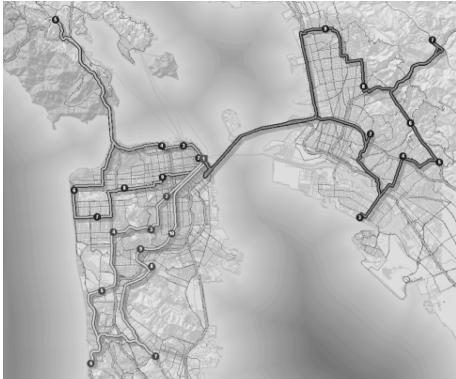
ภาพที่ 2.20 แสดงเส้นทางของรถบรรทุกอาหารสามคันจากศูนย์กระจายสินค้าไปยังร้านค้าต่างๆตามเส้นทางต่างๆเพื่อให้เกิดต้นทุน จำนวนรถน้อยที่สุด
