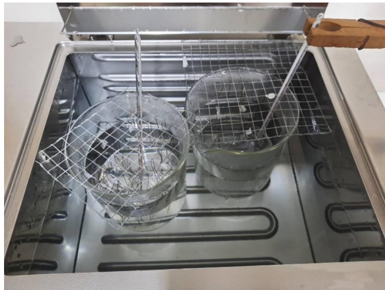
ภาพที่ 3.10 กระบวนการกัดรอย (Etching) แผ่นฟิล์ม CR-39
