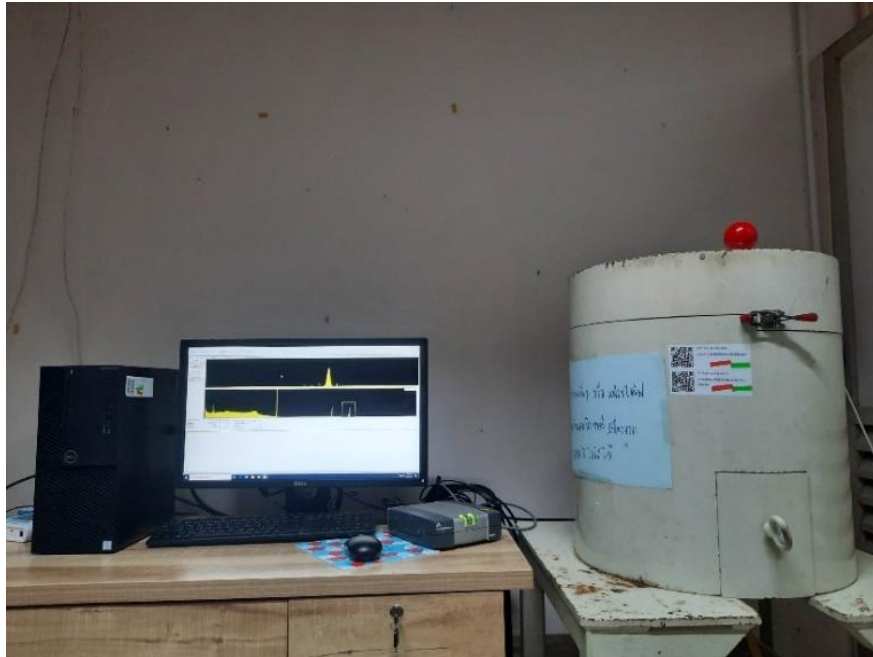
ภาพที่ 2.40 หัววัดรังสีแกมมาแบบสารกึ่งตัวนำชนิดเจอร์มาเนียมบริสุทธิ์สูง (HPGe)
