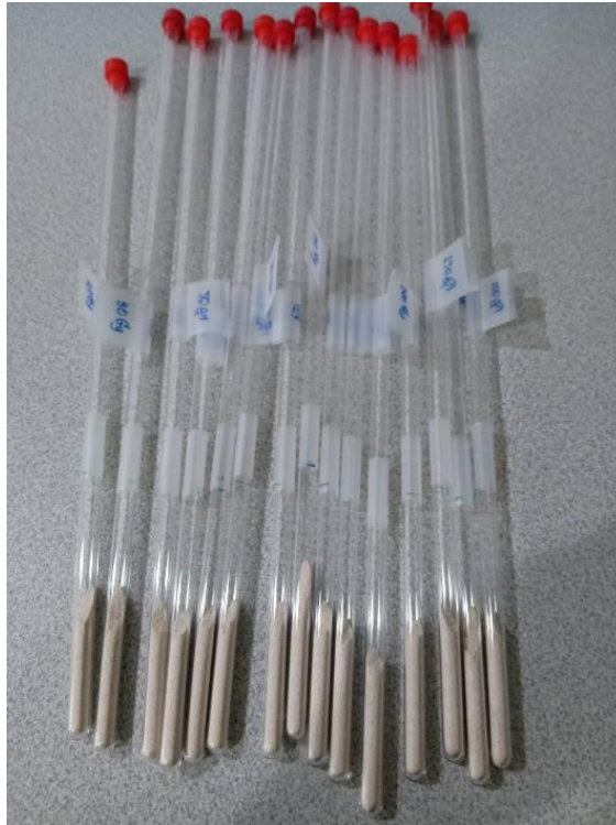
ภาพที่ ง.5 หลอดควอตซ์สำหรับบรรจุตัวอย่างซากหอยน้ำจืดที่บดเป็นผงแล้ว
