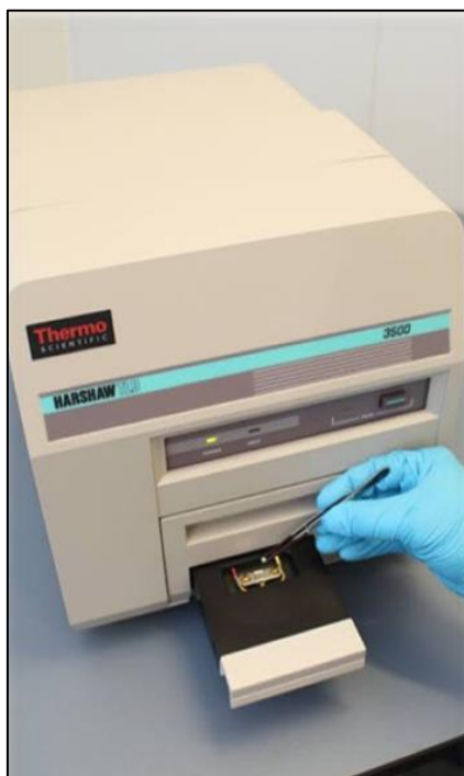
ภาพที่ ค.2 เครื่องเทอร์โมลูมิเนสเซนซ์ รุ่น Harshow-3500
