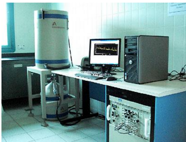
ภาพที่ 2.25 หัววัดสารกึ่งตัวนำชนิดเจอร์มาเนียมบริสุทธิ์สูง
