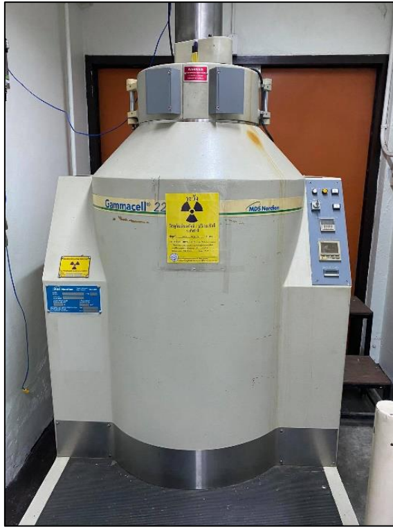
ภาพที่ ค.3 เครื่องฉายรังสีแกมมาจากต้นกำเนิด Co-60 รุ่น Gammacell 220 Excel
