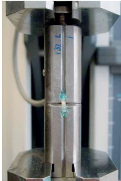
ภาพที่ 9 แสดงแต่ละด้านของชิ้นงานถูกยึดติดกับเครื่องมือในการทดสอบแรงยึดดึง
