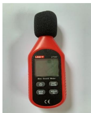
เครื่องวัดความดังเสียง (UNI-T รุ่น UT 353)
