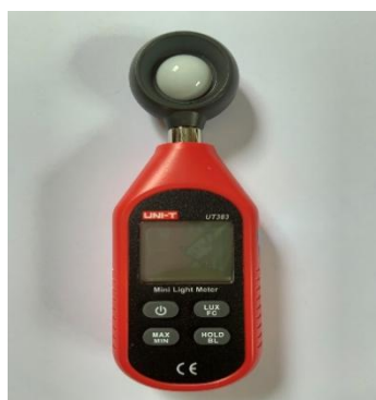
เครื่องวัดความเข้มแสง (UNI-T รุ่น UT 383)
