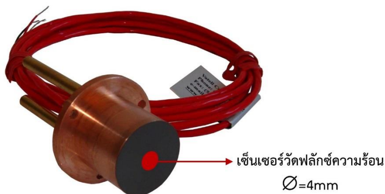
รูปที่ 3.11 เซ็นเซอร์วัดการถ่ายเทความร้อนบนพื้นผิว [33]
