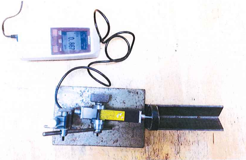
รูปที่ 3.6 การวางชิ้นงานขณะทำการวัดความเรียบผิว
