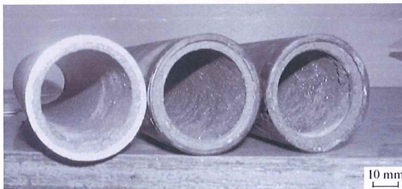
รูปที่ 2.18 ท่อชิ้นงานตัวอย่างที่ผ่านการเคลือบผิวด้วยวิธีการของ Andreev และคณะ (2011)
