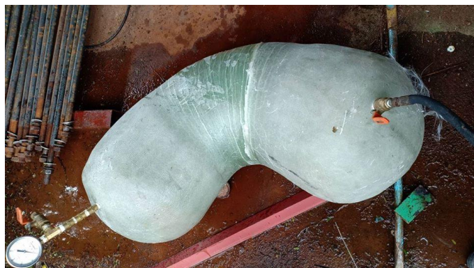
รูปที่ 46 ทดสอบท่อโค้งคอมโพสิตด้วยการอัดแรงดันน้ำ
