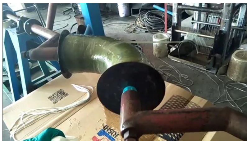
รูปที่ 35 ลักษณะการพันเส้นใยหลังป้อนค่าตำแหน่งที่ได้จากการคำนวณ
