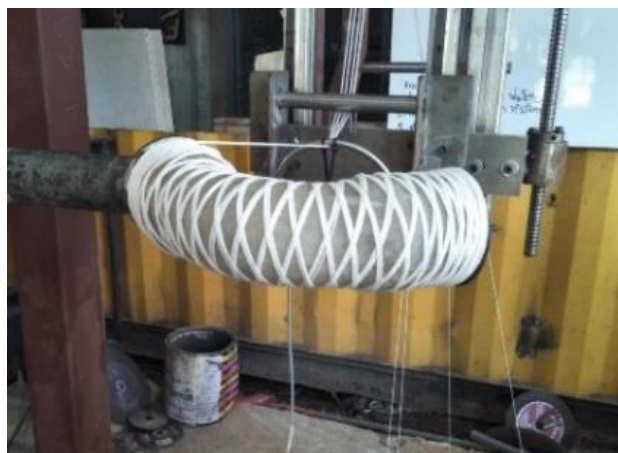
รูปที่ 34 ตัวอย่างการพันเส้นใยที่ได้จากเครื่องจักรแบบสี่แกน
