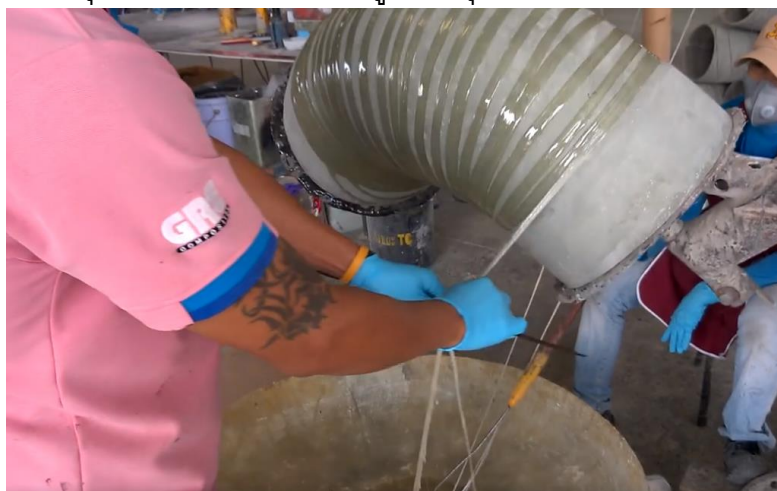
รูปที่ 15 ลักษณะการผลิตท่อโค้งคอมโพลีเมอร์ด้วยแรงงานคนในปัจจุบัน
