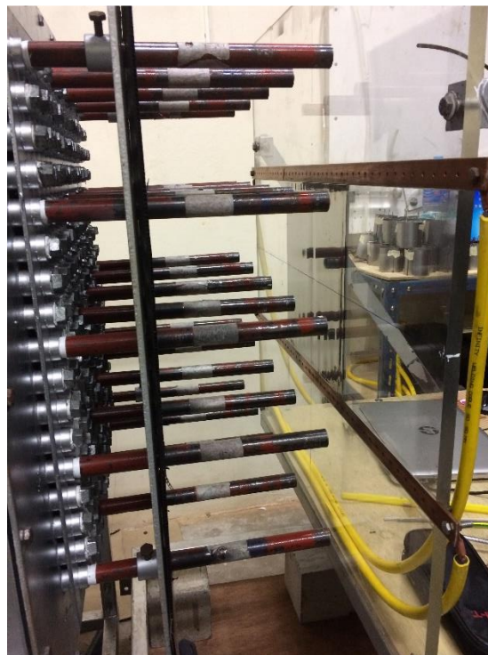
ท่อเจ็ทกรณีที่ไม่ได้ติดตั้งท่อเหนี่ยวนำอากาศ
