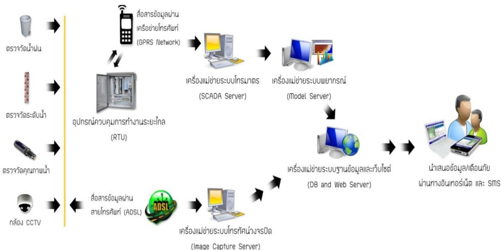
รูปที่ ๓-๒ ระบบตรวจวัดสภาพน้ำทางไกลอัตโนมัติ
