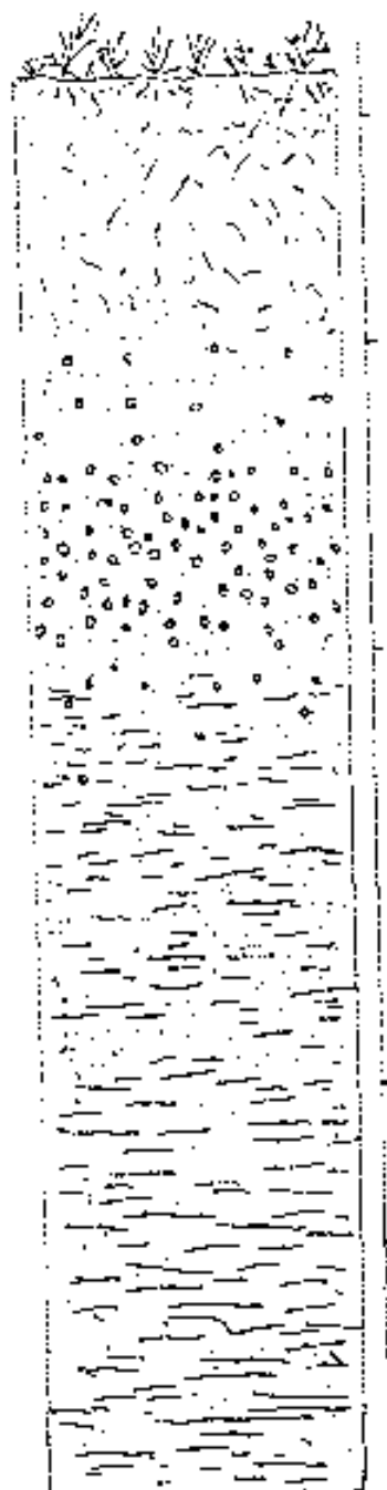
รูปที่ ๔ - ๒ Diagrammatic representation of a lateritic profile (บริษัท ปูนซิเมนต์ไทย จำกัด)
