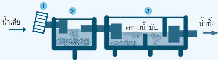
รูปที่ 2.7 บ่อดักและบ่อดักไขมันสถานีบริการน้ำมันเชื้อเพลิง
