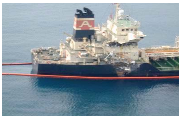
ภาพที่ 38 สภาพเรือ SKY ACE ที่ถูกชน และทุ่นกักคราบน้ำมันที่ล้อมรอบตัวเรือ
