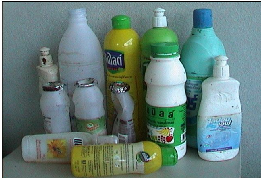
รูปที่ 2-9 ตัวอย่างผลิตภัณฑ์ที่ผลิตจากพลาสติกชนิดโพลีเอทิลีนความหนาแน่นสูง (HDPE)
