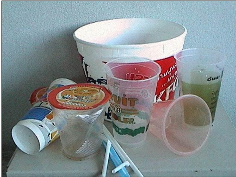
รูปที่ 2-12 ตัวอย่างผลิตภัณฑ์ที่ผลิตจากพลาสติกชนิดโพลิโพรพิลีน (PP)
