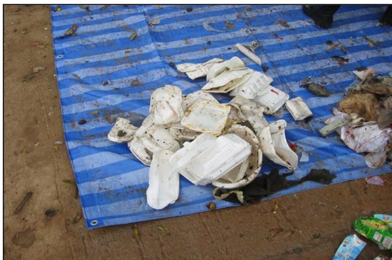
รูปที่ ง-5 ทำการแยกองค์ประกอบประเภทเดียวกัน จากนั้นเตรียมนำไปซังหาน้ำหนักและบันทึกข้อมูล
