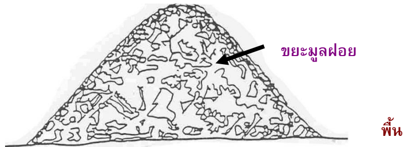
รูปที่ 2-2 ลักษณะการกองขยะมูลฝอยให้เป็นรูปกรวย ก่อนที่จะแบ่งขยะมูลฝอยออกเป็น 4 ส่วน
