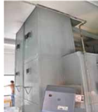
รูปที่ 47 เตาเผาศพแบบสองห้องเผาใช้น้ำมันดีเซลเป็นเชื้อเพลิง
