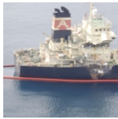
รูปที่ 4 สภาพเรือ SKY ACE ที่ถูกชน และพ่นกักคราบน้ำมันที่ล้อมรอบตัวเรือ
