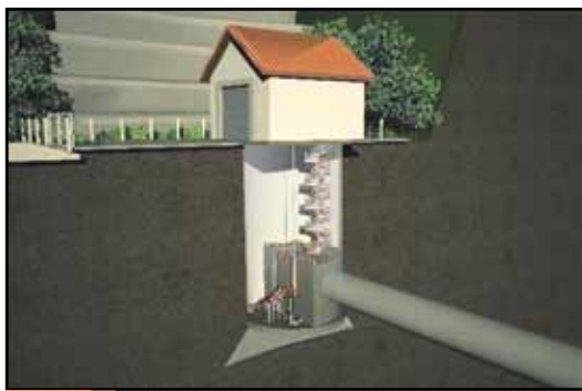
รูปที่ 5 อาคารสูบน้ำออกจากอุโมงค์ลอดแม่น้ำปิง
