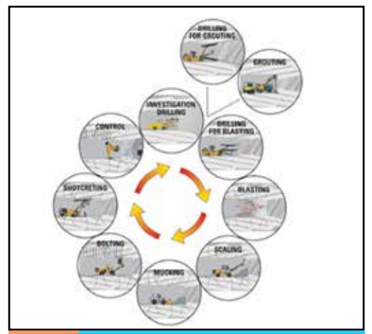
รูปที่ 2 การขุดระเบิดอุโมงค์ (Drill and Blast: D&B)
