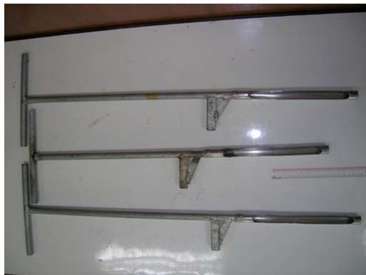
ก. เครื่องเจาะเก็บตัวอย่างดินแบบ Tube auger
