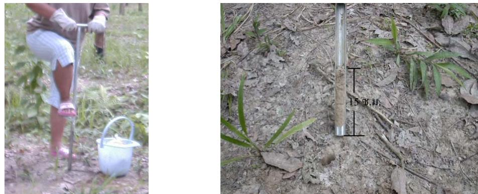
(ก) การเก็บตัวอย่างด้วย Tube auger
