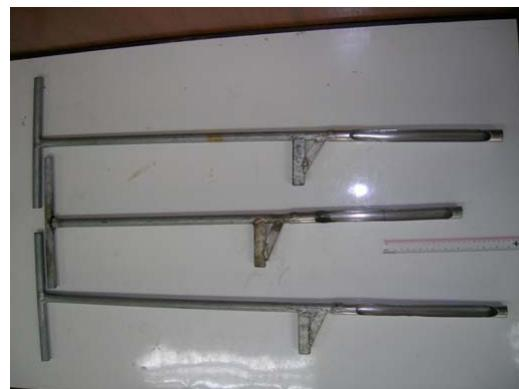
ก. เครื่องเจาะเก็บตัวอย่างดินแบบ Tube auger
