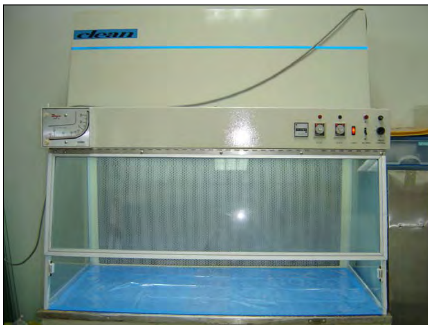
ภาพประกอบที่ ข-1 ตู้ปลอดฝุ่น (laminar flow cabinet) class 100
