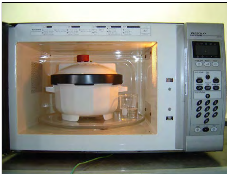
ภาพประกอบที่ ๓-4 การวางหม้ออัดความดันและบีกเกอร์ที่บรรจุน้ำไว้ภายในไมโครเวฟ
