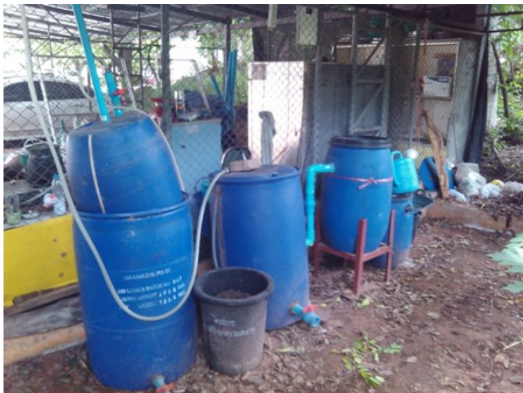
การนำขยะมาผลิตเป็นพลังงานที่แพร่หลายที่สุดในประเทศไทย ก็ยังคงเป็นถังหมักก๊าซชีวภาพอยู่ เนื่องจากใช้เทคโนโลยีแบบง่ายๆ และต้นทุนต่ำ
