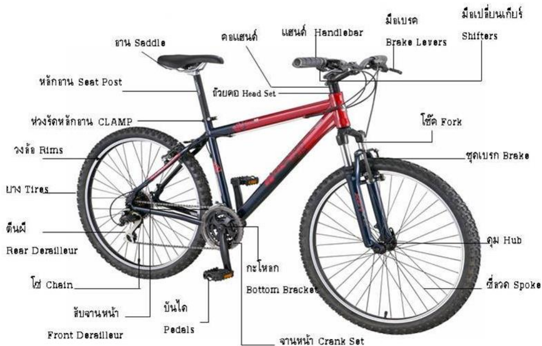
ภาพที่ 2.1 รูปภาพแสดงส่วนประกอบที่สำคัญของรถจักรยาน ที่มา : หนังสือวารสารMTB SPECIAL, VOL.13, หน้า 22(2558)
