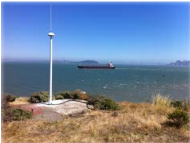
เรดาร์ความถี่สูงที่ตั้งขึ้นในรูปได้ถูกติดตั้งบริเวณปากอ่าวซานฟรานซิสโก เพื่อส่งข้อมูลกระแสน้ำให้ทาง NOAA รูปนี้ได้มาจากมหาวิทยาลัยซานฟรานซิสโก
