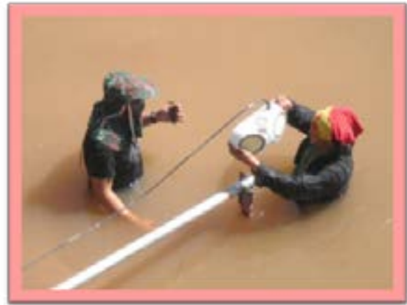
รูปที่ 11 สถานที่ติดตั้งเครื่องวัดกระแสไฟฟ้าแบบ Acoustic ชนิด 500 Khz
