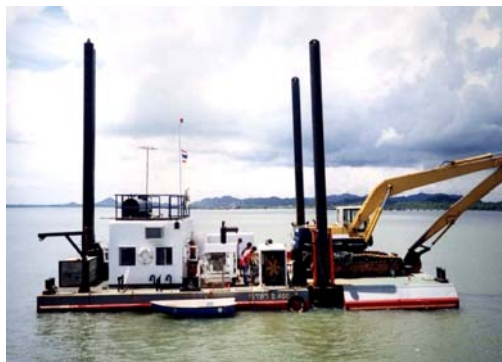
ภาพที่ 36 รถขุดตักดินไฮดรอลิก (รถแบคโฮ) และ โป๊ะสำหรับรองรับรถขุด
