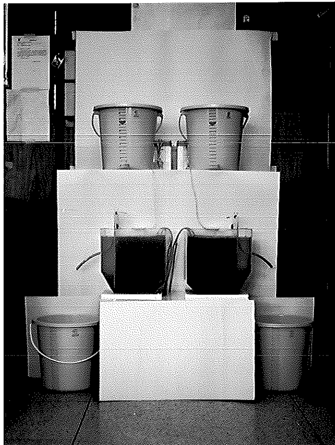
ภาพประกอบ ๑ แสดงลักษณะชุดประกอบของระบบบำบัดน้ำเสียจำลอง แบบ Activated Sludge
