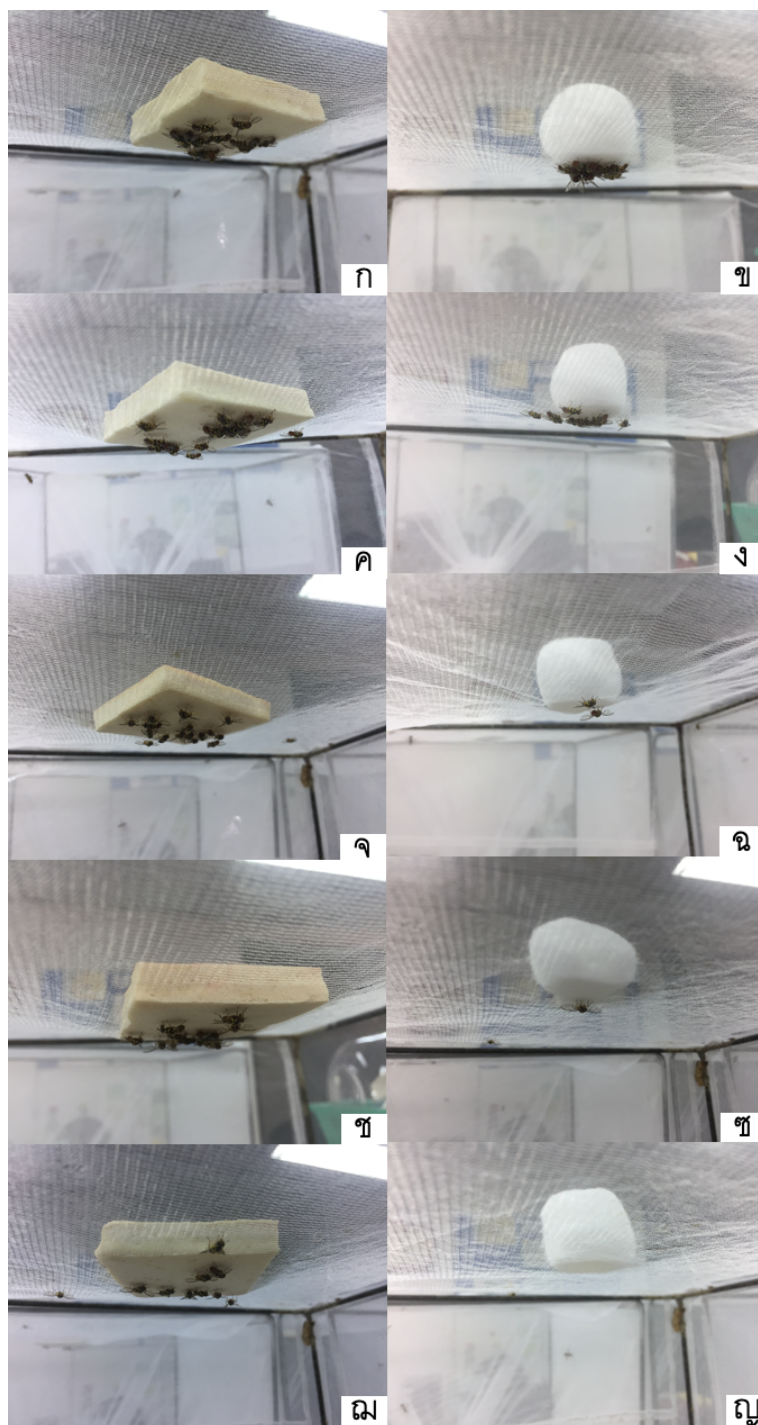
ภาพที่ 18 เปรียบเทียบประสิทธิภาพความคงทนต่ออุณหภูมิสูงของโพนยางพารา (ก, ข, จ, ช, ฉ) และสำลี (ข, ง, ฉ, ช, ญ) ที่ผสมสารฟีโรโมนเมทิลยูจินอลต่อการดึงดูดแมลงวันผลไม้เพศผู้ Bactrocera dorsalis (Hendel) ที่อุณหภูมิ 25, 35, 45, 55 และ 65 องศาเซลเซียส
