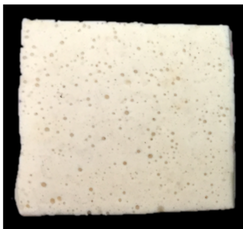
ภาพที่ 5 โคมยางพาราขนาดมาตรฐาน (กว้าง x ยาว x หนา) 5.0 x 5.0 x 1.0 เซนติเมตร
