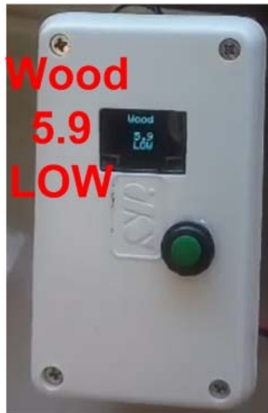
รูปที่ 7 ค่าความชื้นที่อ่านได้ค่าต่ำ
