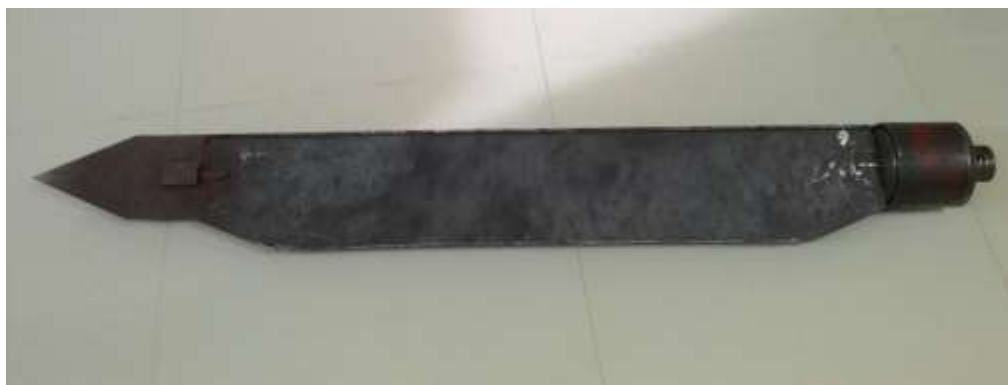
รูปที่ 3.1 ตัวอย่างแท่งเก็บตะกอนดินแบบ Russian corer
