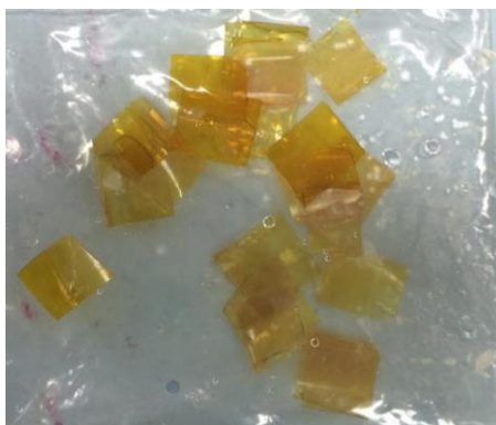
ภาพที่ 3-10 แผ่นเอนไซม์ตรึงรูปที่ใช้ในการบำบัดน้ำเสียเบื้องต้น ขนาด 1x1 cm ตรึงด้วยความเข้มข้นเอนไซม์ 140 \mu\text{g/ml}
