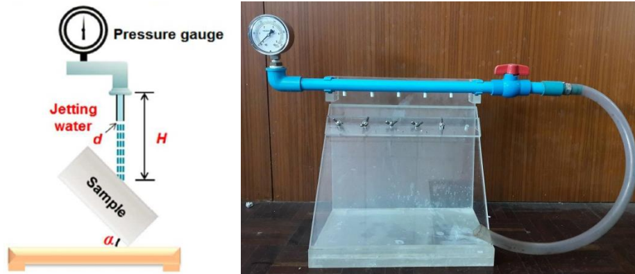
รูปที่ 3.14 แสดงไดอะแกรมและชุดทดสอบความคงทนต่อการกัดเซาะของกระแสน้ำ (water jet impact test)
