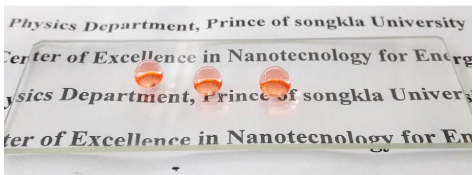
รูปที่ 4.10 แสดงภาพถ่ายหยดน้ำบนสารเคลือบ OH-PDMS ที่ผ่านกระบวนการ MW-PECVD ในเวลา 5 วินาที ซึ่งสารเคลือบที่แสดงสมบัติไม่ชอบน้ำอย่างยิ่งยวดและความใสสูง
