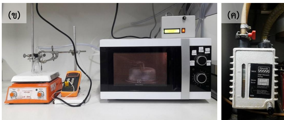
รูปที่ 4.1 แสดงไดอะแกรมของระบบเคลือบไอเคมีโดยอาศัยไมโครเวฟพลาสมา (ก) และระบบเคลือบไอเคมีโดยอาศัยไมโครเวฟพลาสมาที่ใช้ในการทดลองซึ่งประกอบด้วยห้องเคลือบไมโครเวฟ (ข) และปั๊มโรตารี (ค)
