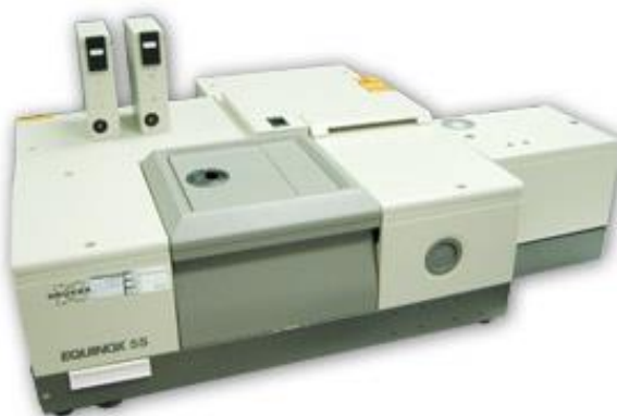
รูปที่ 3.12 แสดงเครื่อง Fourier transform infrared (FT-IR) spectrometer บริษัท Bruker รุ่น EQUINOX 55
