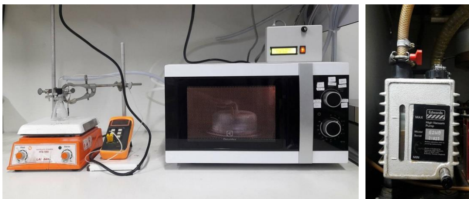
รูปที่ 3.3 ระบบเคลือบผิวด้วยเทคนิคการเคลือบไอเคมีโดยอาศัยไมโครเวฟพลาสมา
