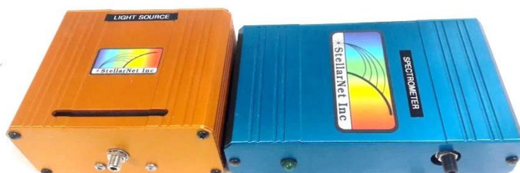
รูปที่ 3.11 แสดงเครื่องกำเนิดแสงในช่วงความยาวคลื่น 400-800 นาโนเมตร (ซ้าย) และเครื่อง Spectrometer blue-wave visible บริษัท StellarNet (ขวา)
