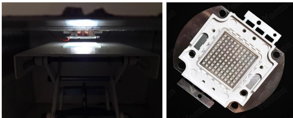
รูปที่ 3.13 แสดงชุดการทดสอบความคงทนจากแสง UV และหลอดไฟ LED 100 วัตต์ กำเนิดแสงช่วงความยาวคลื่น 364-370 นาโนเมตร
