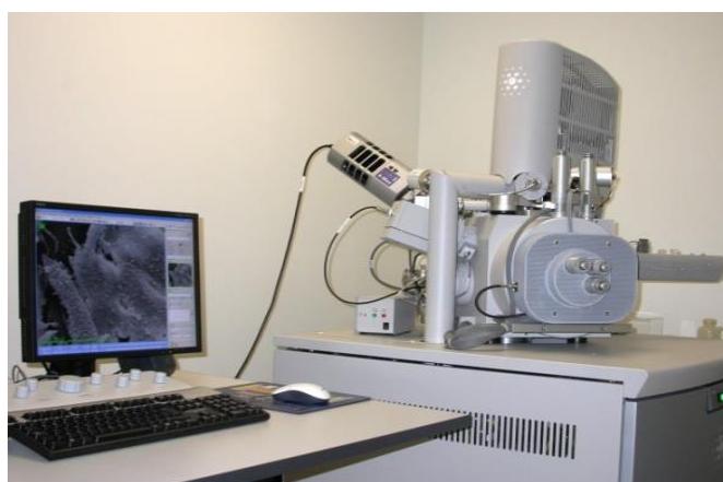
รูปที่ 3.7 แสดงกล้องจุลทรรศน์อิเล็กตรอนแบบส่องกราด (SEM) รุ่น Quanta-400
