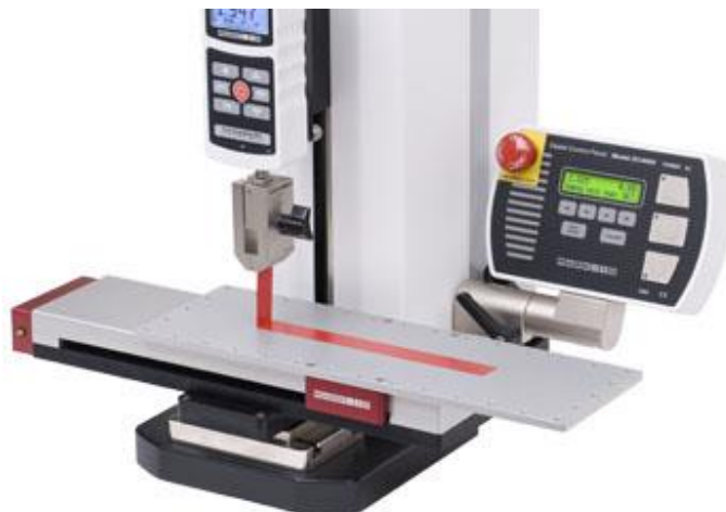
รูปที่ 1.3 แสดงเครื่องทดสอบความคงทนโดยใช้เทคนิคการหลุดลอกของเทปกาว (tape peeling test)
